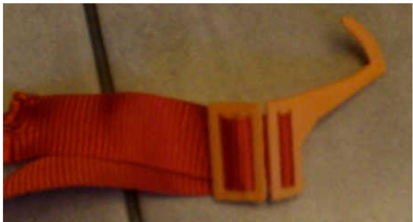
**Ces modèles de crochets sont différents pour pouvoir s'adapter au type de déambulateur de la personne handicapée**, et la personne elle-même selon ses facilité d'utilisation d'un modèle ou de l'autre.
