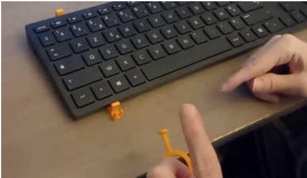
En résumé, **quatre tailles de rails** pour des modèles différents de clavier d'ordinateur, **et des anneaux à large bord, mobiles et faciles à enlever** pour pouvoir déplacer très facilement son clavier d'ordinateur **malgré ses difficultés de préhension**....
