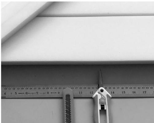
*Le panneau en mousse polyuréthane est découpé, à l'aide d'un cutter en amont.*
